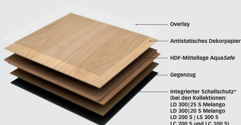
\*Bei der Verlegung von MEISTER-Laminat mit integriertem Schallschutz ist die Verwendung einer losen Dämmunterlage nicht erforderlich.
