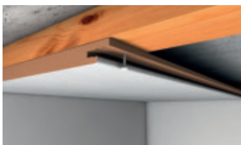
Die Befestigung mit den MEISTER-Spezialschrauben Nr. 20 erfolgt bei der neuen Verlegemechanik unverändert an der Nutseite.
